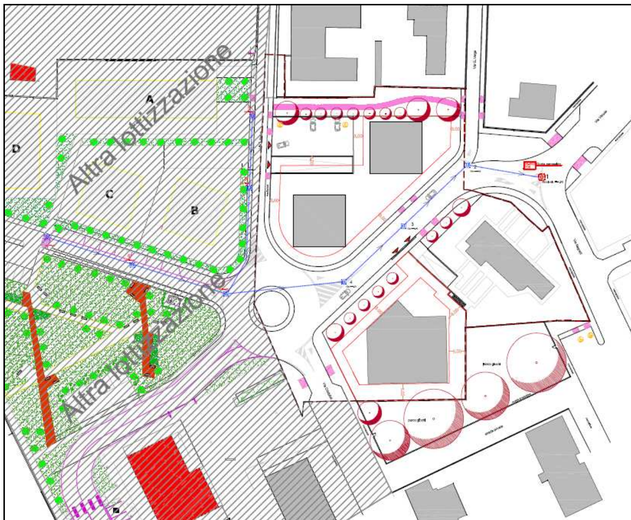
Figura 4: Disegno in pianta delle future lottizzazioni con indicati i tratti di fognatura nera.
